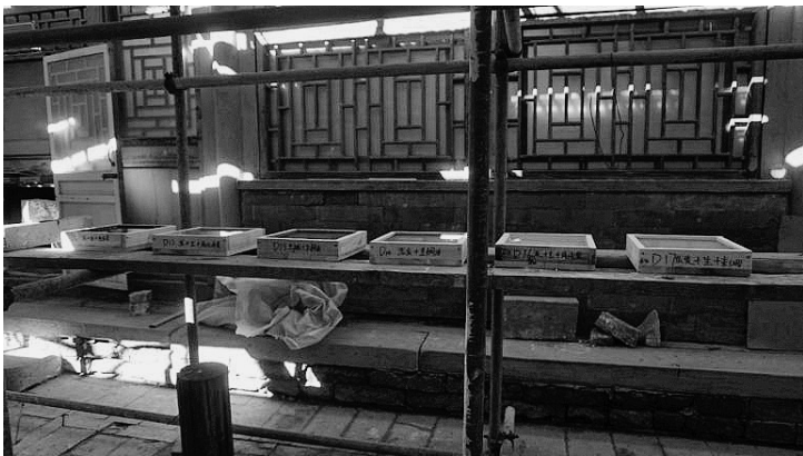
图9 D组闭水实验（部分材料筛选板）
