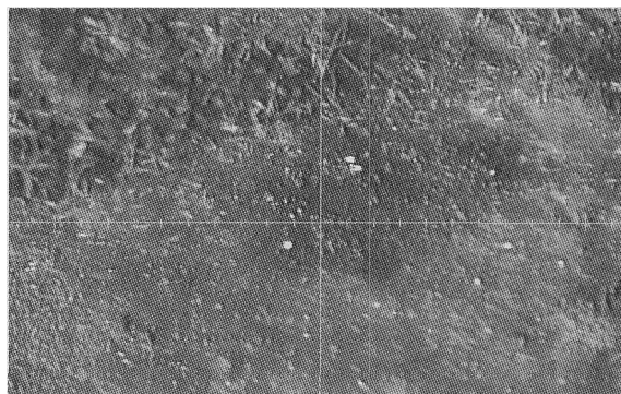
图 3 唐铜镜锈样深绿色锈蚀视频图
