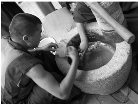
图 13 用骨刮将金泥刮到一边并将脏水舀出
