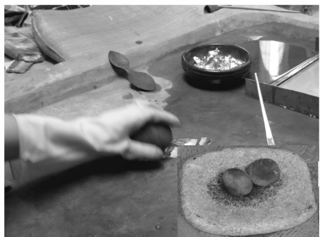
图 19 用小磨石磨制金泥
