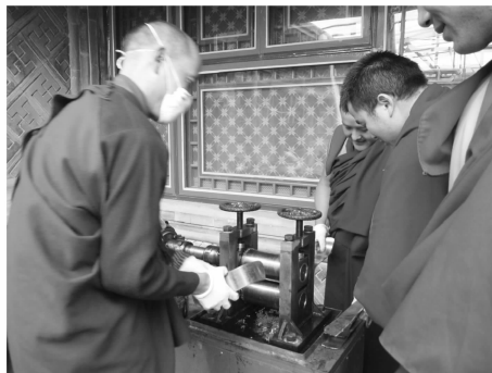
图4 将金砖进行压轧
