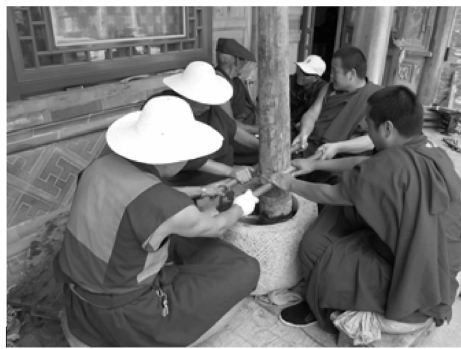
图 12 用石磨再加工金泥
