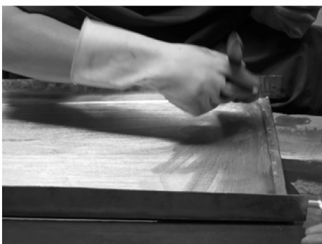
图 22 用毛刷将金泥刷匀
