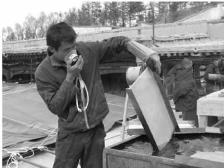
图25 将瓦件放入冷却池中冷却
