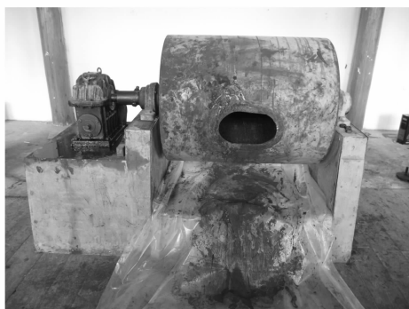
图 10 用球毛机将金泥再加工
