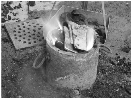
图1 用煤炉将金砖烧红
