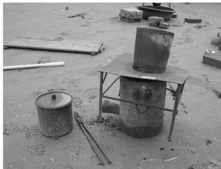
图 8 用煤炉加热金+汞混合物
