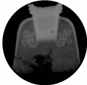
(b) YW-0892 铁铲，电压 78.9kV，电流 0.08mA
