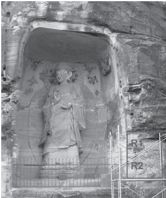
图2 防风化保护材料现场试验区R1、R2
