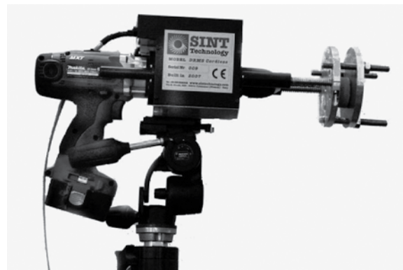
图3 现场试验中使用的抗钻强度测试仪
