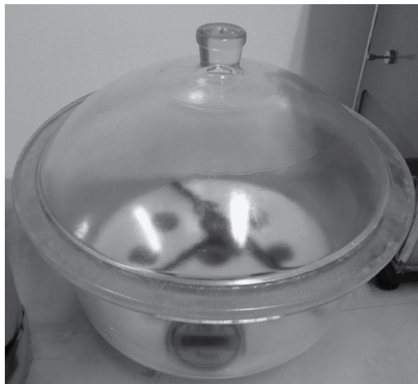
图4 用于观察腐蚀活泼性的湿润室
