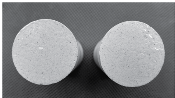
图11 R6组20%涂刷两遍后的渗透情况
