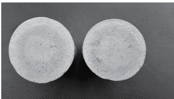
图10 R5组15%涂刷两遍后的渗透情况
