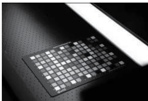
图4 用SG色卡制作扫描仪的ICC文件
