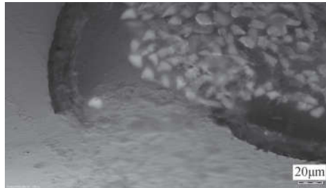
图20 “万寿无疆”匾金线1剖面（500×，紫外光）
