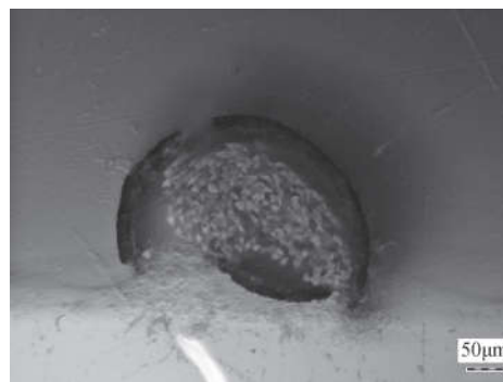
图19 “万寿无疆”匾金线1剖面 (200×, 紫外光)
