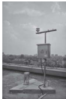
图9 室外超声波气象站
