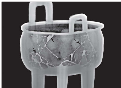
图3 X射线成像及显示为黑色缝隙的虚焊处（箭头所示）
