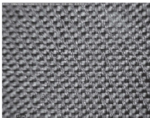
图9 织物表面组织结构图（60×）
