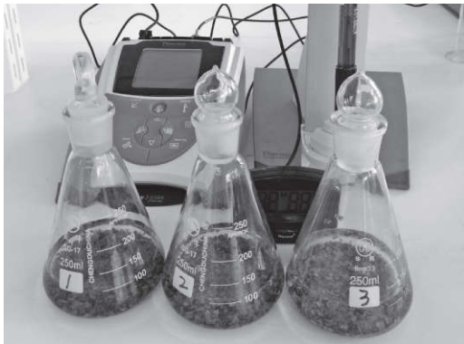
图4 冷抽提法测定pH
