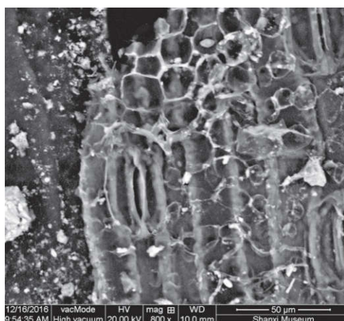
图24 平遥壁画粗泥层中加筋材料SEM图
