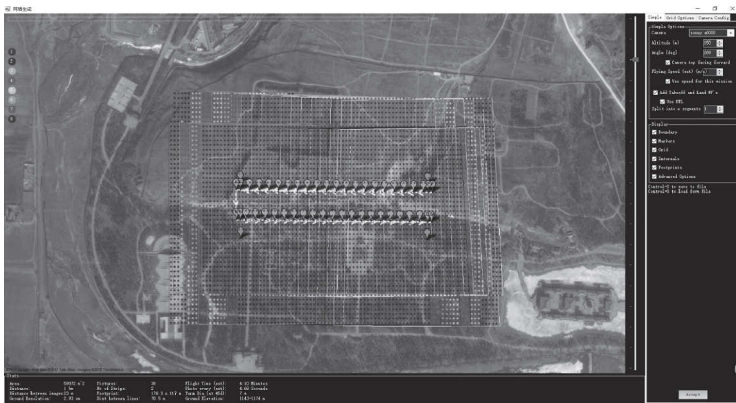
图4 无人机航线拍摄点位以及拍照覆盖面积
