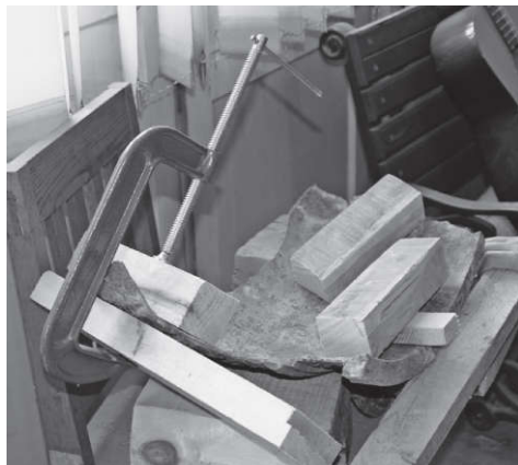
图3 使用U形夹钳及木条整形
